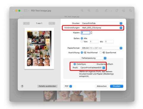
Abbildung 6: Anwenden des in colymp exportierten ICC-Profils: Im Druck-Dialog eines beliebigen Programms muss unter Farbanpassung (Color Matching) zunächst ColorSync und unter Profil das zuvor in colymp exportierte ICC-Profil (hier im Beispiel »CanonPrintFabMatt600«) ausgewählt sein. Es ist lohnenswert, die gesamten Einstellungen im Druck-Dialg als Voreinstellung (Preset) zu speichern - in diesem Beispiel als »Matt\_600\_CScolymp«.
