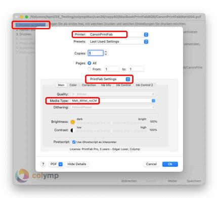
Abbildung 3: In colymp wählen Sie den gewünschten PrintFab Drucker. In den PrintFab Einstellungen (PrintFab Settings) wählen Sie unter Medientyp (Media Type) das in Schritt Punkt 1 erstellte PrintFab-Profil (»Matt\_Mittel\_noCM«).
