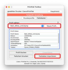
Abbildung 7: Importieren der Farbinformationen (ICC-Profil) in PrintFab: Es wurde zunächst ein neues PrintFab-Profil erstellt (»Matt\_Mittel\_cmColymp«). Anschließend kann das von colymp exportierte ICC-Profil durck Klick auf Farbdaten importieren importiert werden.
