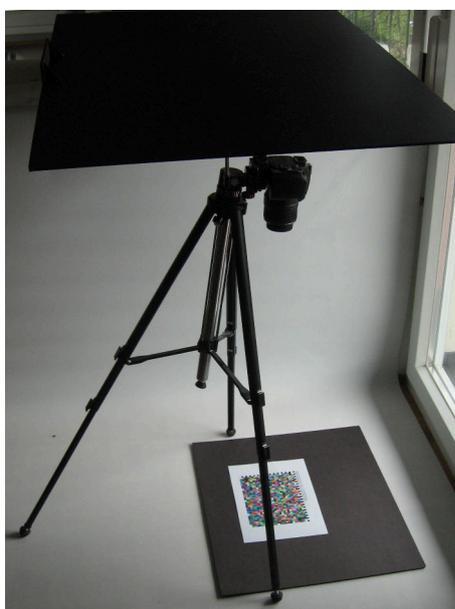
FIGURE 43 – Réduire les réflexions : placer un carton noir derrière la caméra.
