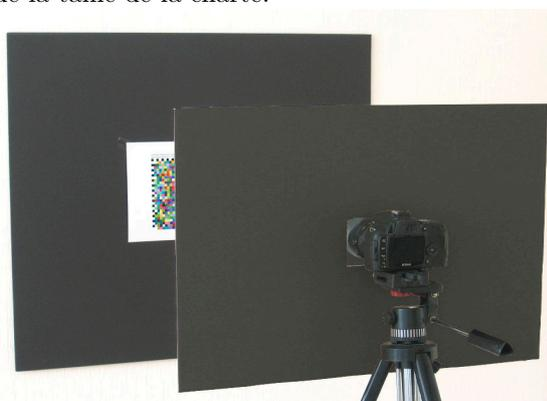
FIGURE 44 – Réduire les réflexions : placer un carton noir avec un trou devant la caméra.
