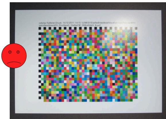
Abbildung 14: Reflexion durch Beleuchtungslicht (oben rechts): ⇒ unbrauchbar!
